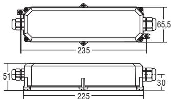
**ST2 IP67****Alimentatori elettronici in corrente continua IP67.**
