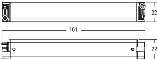
**SLIM IP65 HPFU****Alimentatori elettronici in corrente continua resinati IP65.**
