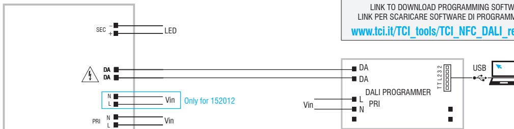
Programming via DALI - Programmazione tramite DALI
