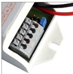
Jumper per settaggio massima tensione di uscita
