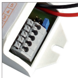
Jumper per settaggio massima tensione di uscita
