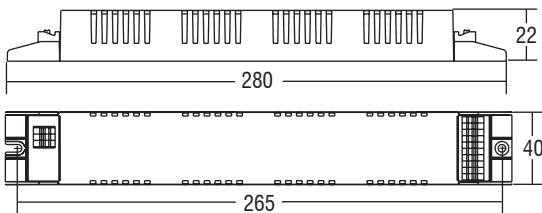
**BTL 3x-4x Plastic****Reattori elettronici lineari multilampada-multipotenza.**
