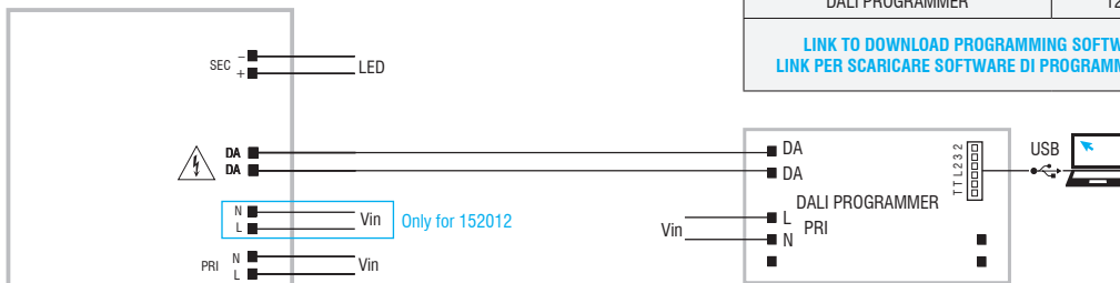
Programming via DALI - Programmazione tramite DALI
