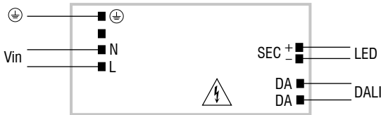
DALI diagram Collegamento DALI
