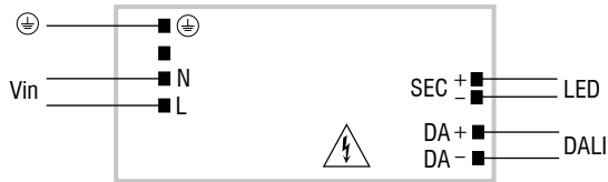
Active DALI diagram Collegamento DALI attivo
