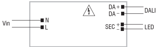
Active DALI diagram Collegamento DALI attivo
