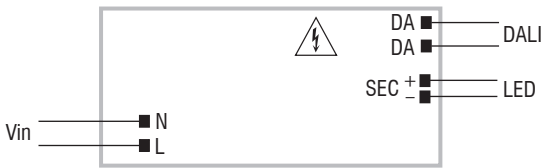
DALI diagram Collegamento DALI
