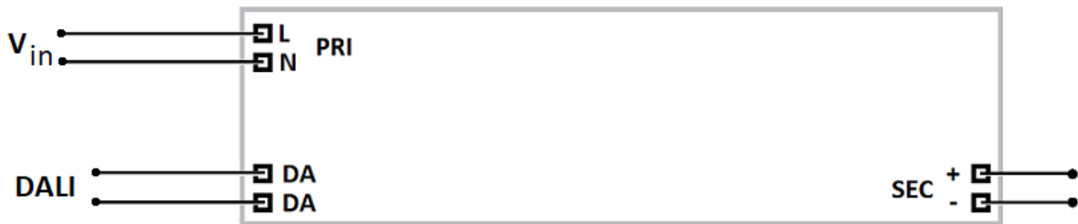
DALI connection diagram Schema di connessione DALI
