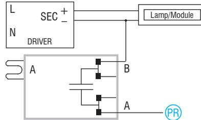
PR: Connessione alla superficie di metallo della lampada.
